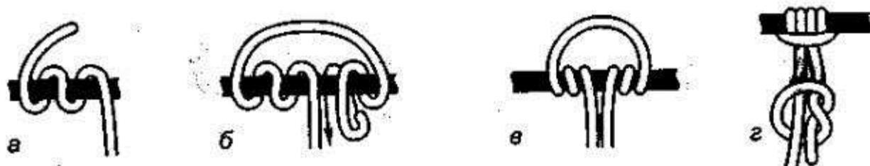
**Рис. 70. «Схватывающий» узел одним концом**
